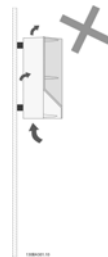
Afbeelding 3.3: Afgezien van A2- en A3-behuizingen kunnen eenheden niet worden gemonteerd op de aangegeven wijze zonder achterwand. De koeling zal in dat geval onvoldoende zijn en dit kan de levensduur van de eenheid aanzienlijk verkorten.
