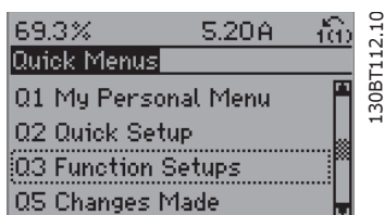
Afbeelding 6.4: Stap 3: gebruik de navigatietoetsen omhoog/omlaag om naar Functiesetups te schuiven. Druk op [OK].
