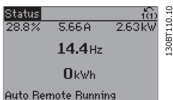
Afbeelding 6.2: Stap 1: schakel de frequentieomvormer in (gele LED gaat branden).
